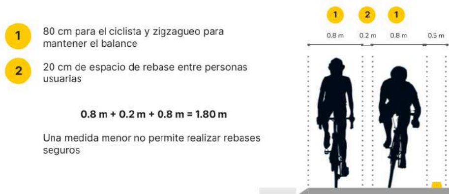
Imagen 25. Distancias mínimas para el rebase seguro en infraestructura ciclista
